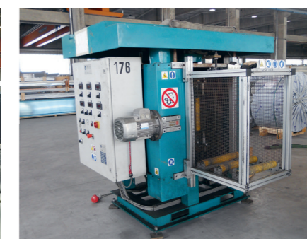
ПРИМЕР ВАЛЬЦОВОЧНОГО СТАНКА ДЛЯ РАДИУСНОГО ИЗГИБА ПАНЕЛЕЙ
